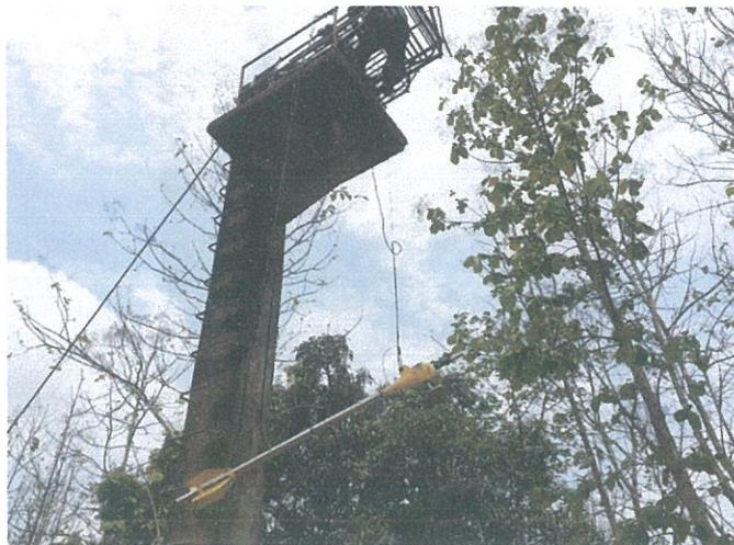
**Figura 2:** Preparación del escandallo para la ejecución de aforos en la estación Zapotal en Lechugal (Cod. H0346). Fecha: 16/11/2021
