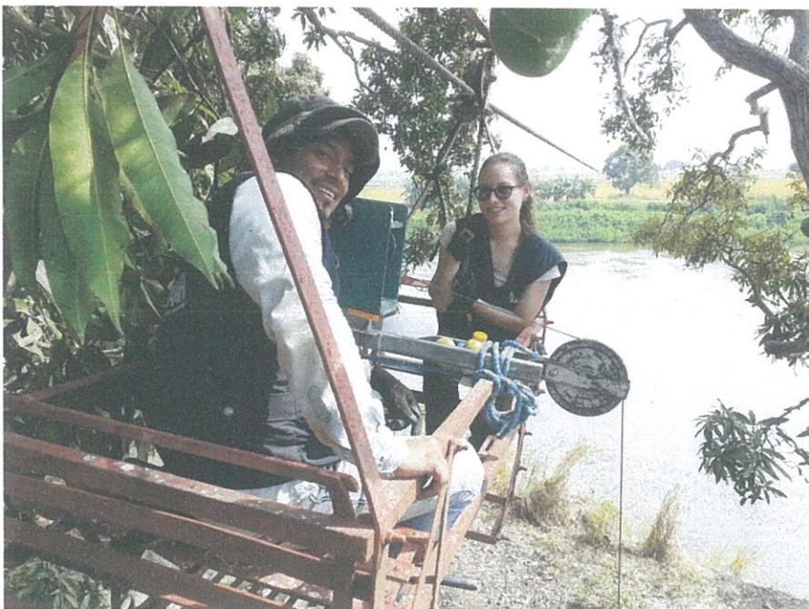
**Figura 6:** Aforo líquido mediante el uso de escandallo en la estación Daule en la Capilla (Cod. H0365). Fecha: 19/11/2021
