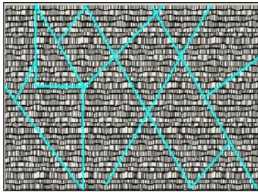
Porosidad por fisuración
