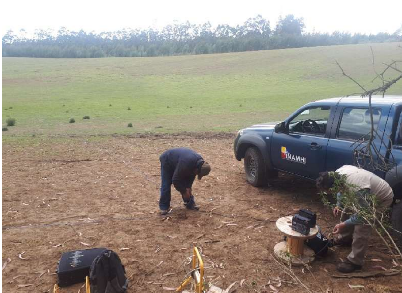
Campaña de levantamiento de datos geofísicos 2018 - Transitorios electromagnéticos
