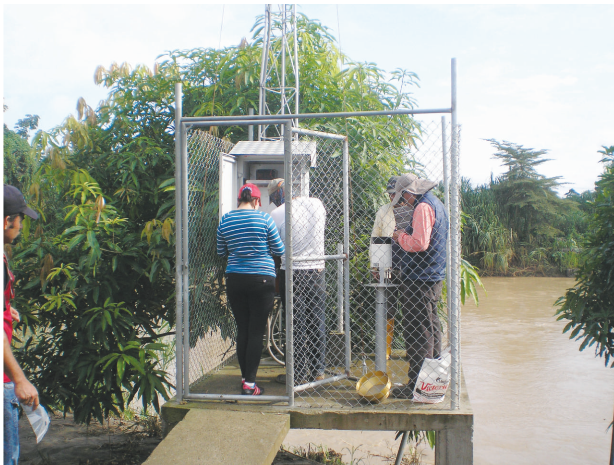
Técnicos del Inamhi en tareas de mantenimiento en la estación H0472 Cañar-Puerto Inca (SAT Cañar).
